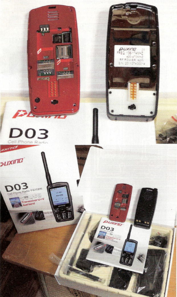
Ve stánku firmy ELIX jsme vyfotografovali tuto pozoruhodnou novinku: PUXING D03, což je FM transceiver pro pásma 145 a 435 MHz, mobilní telefon a MP3 přehrávač v jednom. Telefon (červený díl vlevo) a transceiver (černý díl vpravo) je možno používat buď odděleně, nebo je secvaknout dohromady
