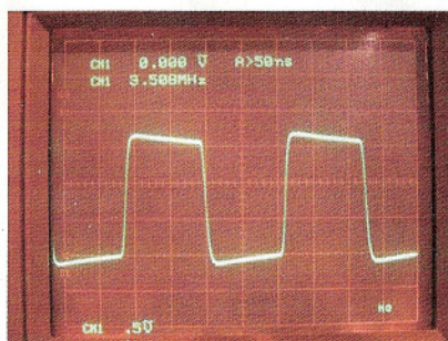
Obr. 8. Tvar výstupního průběhu na obrazovce osciloskopu: zleva pásmo 3,5, 14 a 28 MHz
