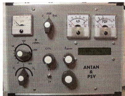
Obr. 5. Fotografie předního panelu vzorku analyzátoru s možností přepínat mezi původním můstkem a měřičem PSV
