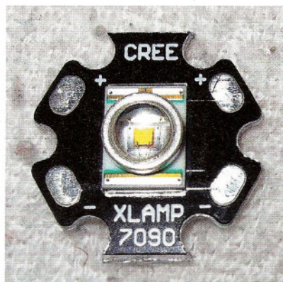
Obr. 6. Modul LED o výkonu 0,5 W od firmy CREE
